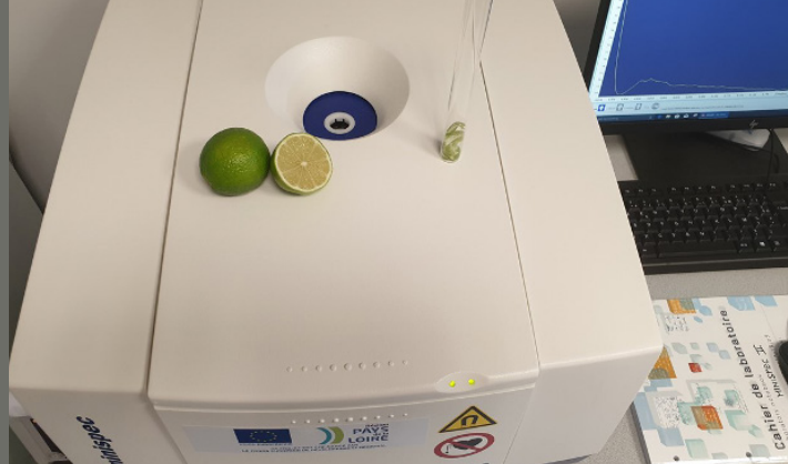
©INRAE - Loïc Foucat et Estelle Bonnin - Spectromètre RMN bas champ
