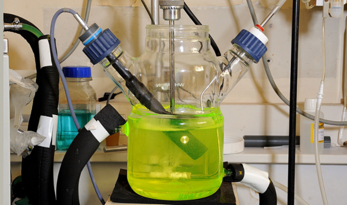
Dircom Cnam ©Sandrine Villain - Détermination du coefficient de transfert d'oxygène dans un bioréacteur
