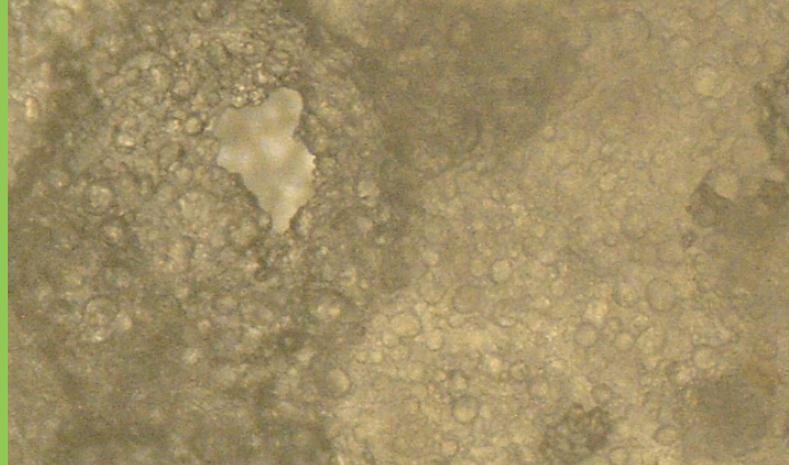
©Kossigan Bernard Dedey - Observation mésoscopique en continu d'un film de pâte pendant son gonflement sous forme de bulle dans une cellule conçue au laboratoire qui contrôle température et composition en gaz.
